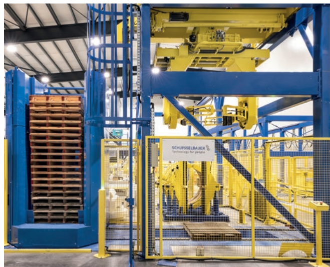
Palety składowane są w stosach i automatycznie wprowadzane do obiegu.
