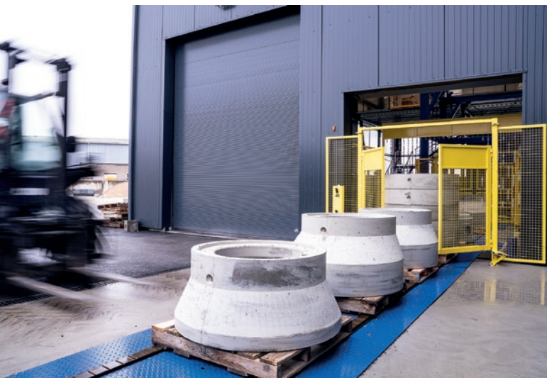
Rozformowane prefabrykaty już na paletach po opuszczeniu hali produkcyjnej.
