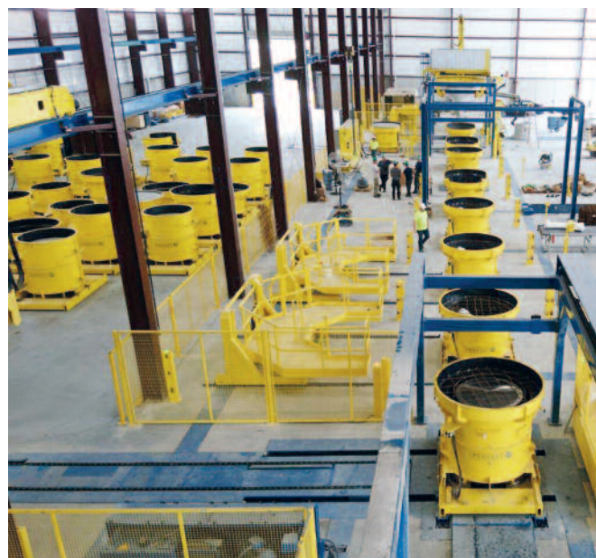
System Perfect Forming Technology w zakładzie produkcyjnym firmy CP&P w Ashland to najbardziej wydajna produkcja podstaw studni na amerykańskim rynku.
