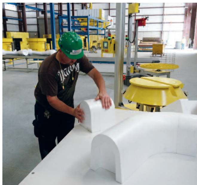
Prefabrykowane kształtki EPS zostają przycięte w wycinarkach i w łatwy sposób złączone w negatyw kinety.
