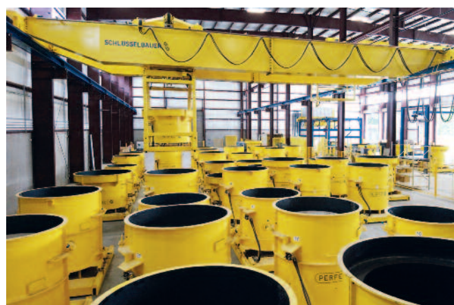
Łatwe w obsłudze formy zapewniają wydajność i elastyczność - niezbędne przy produkcji podstaw studni.
