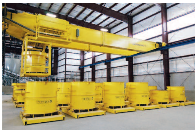
Zalane formy obsługiwane są przez automatyczną suwnicę, co eliminuje opóźnienia związane z manualną obsługą oraz ruch wózków widłowych w obszarze produkcyjnym.
