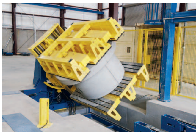
Stacja do obracania wyrobów z dnem o zwiększonej średnicy jako zabezpieczeniem przed wyporem.
