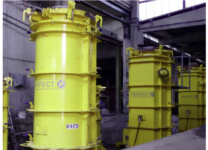
W firmie Beton Müller, w specjalnie przygotowanej hali, ustawione są formy do rur o średnicach od DN 700 do DN 1200.
