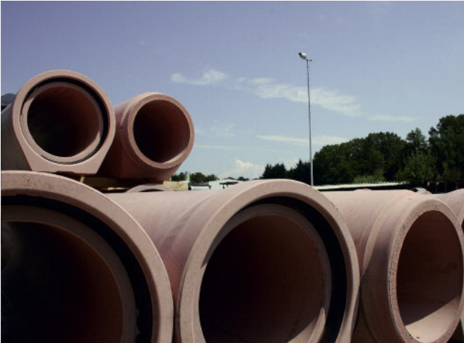
Także rury o średnicach kl. 2 i 3 wykonywane są ze stopką. Na zdjęciu rury betonowe DN 800.
