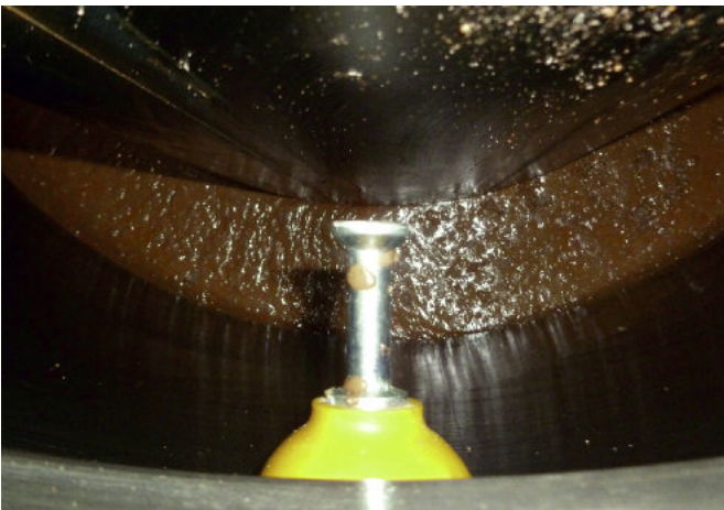
Podczas napełnienia form płynnym betonem zalewane są także kotwy transportowe.
