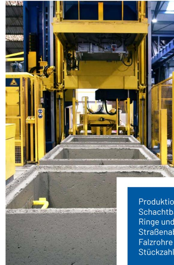
Produktionsanlage für Schachtbauteile wie Ringe und Konen sowie für Straßenablaufteile und Falzrohre in großen Stückzahlen
