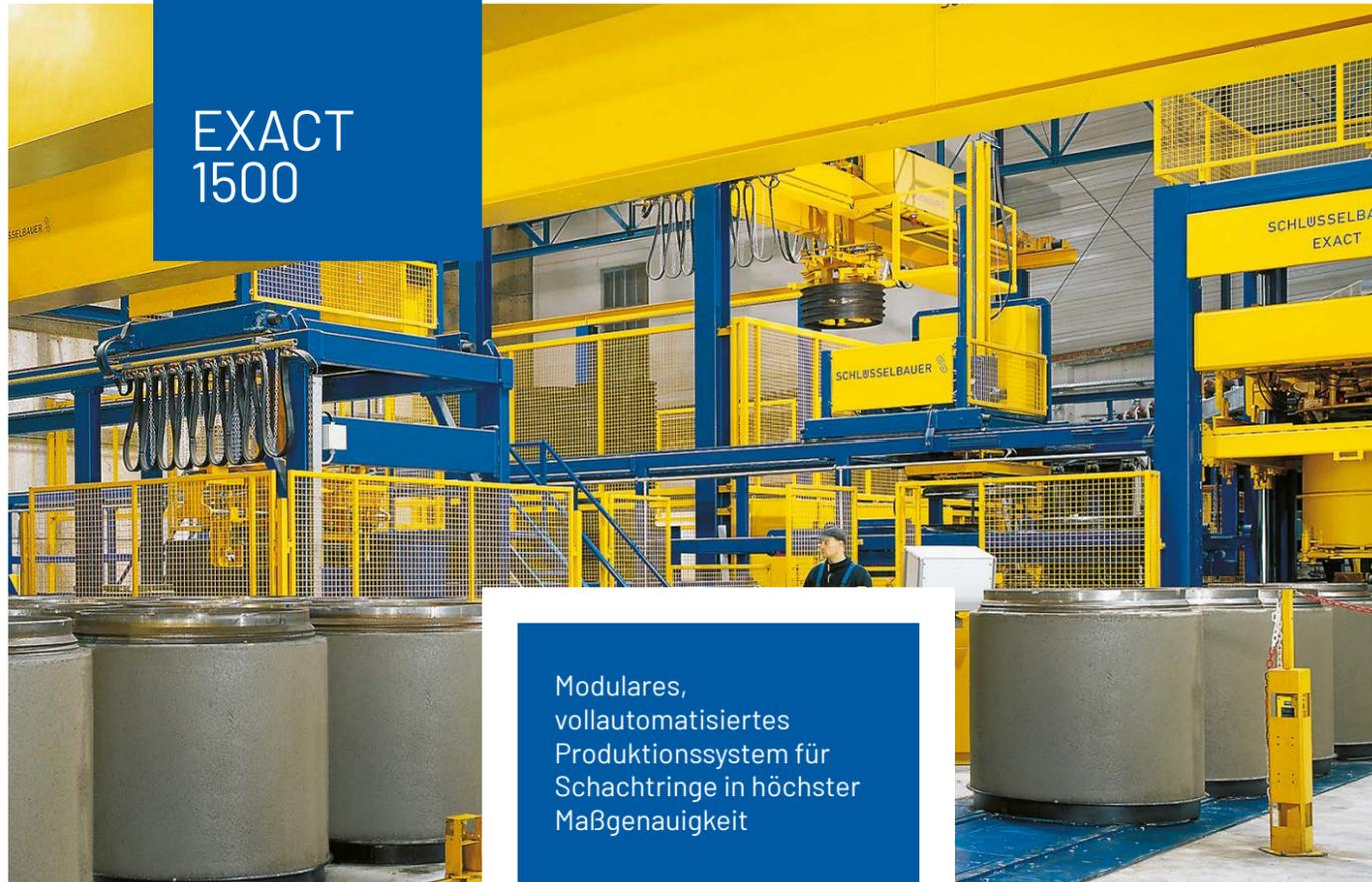
Modulares, vollautomatisiertes Produktionssystem für Schachtringe in höchster Maßgenauigkeit
