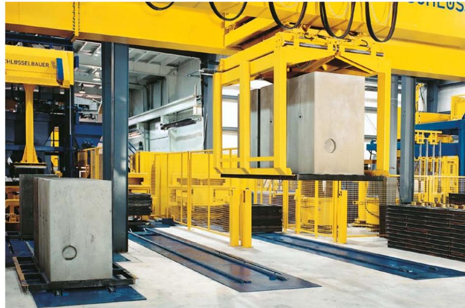
Produktionsanlage für Schachtbauteile sowie bewehrte und unbewehrte Rohre, Entwässerungsrinnen und Gelenkstücke
