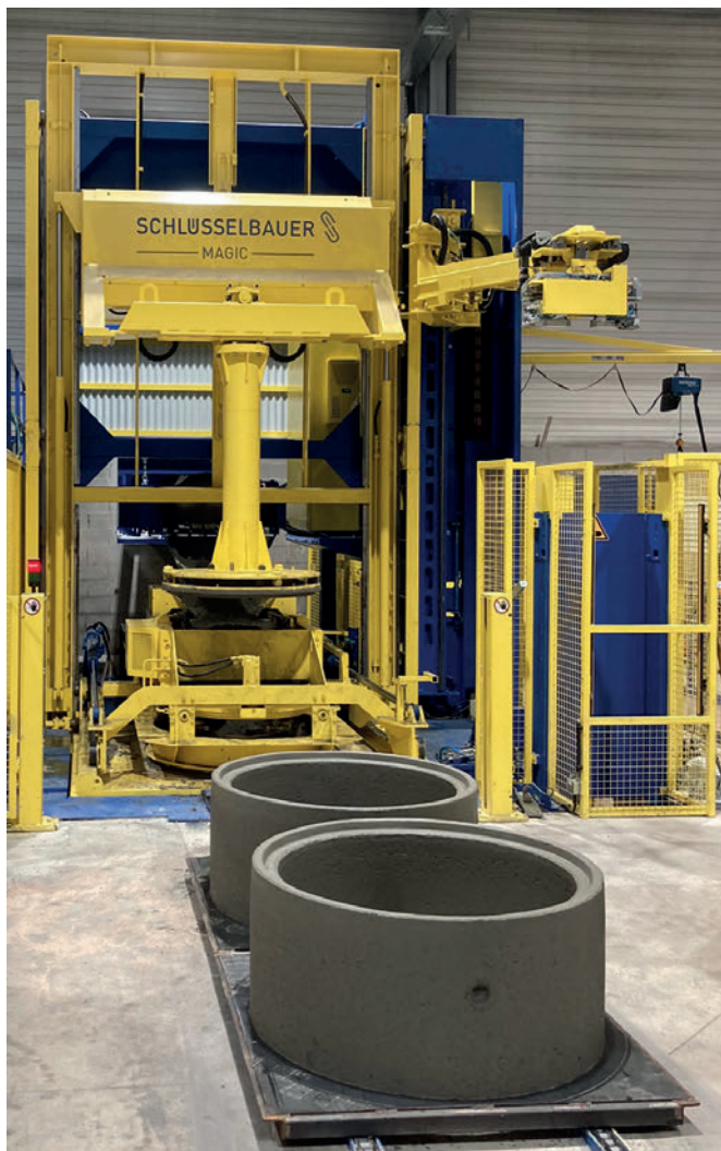
La mise en place automatique des ancrs comme celle des échelons s'effectuent ici par la droite et la trémie est déportée derrière le mur du bâtiment : la Magic a été adaptée sur mesure en fonction du site Plattard.
