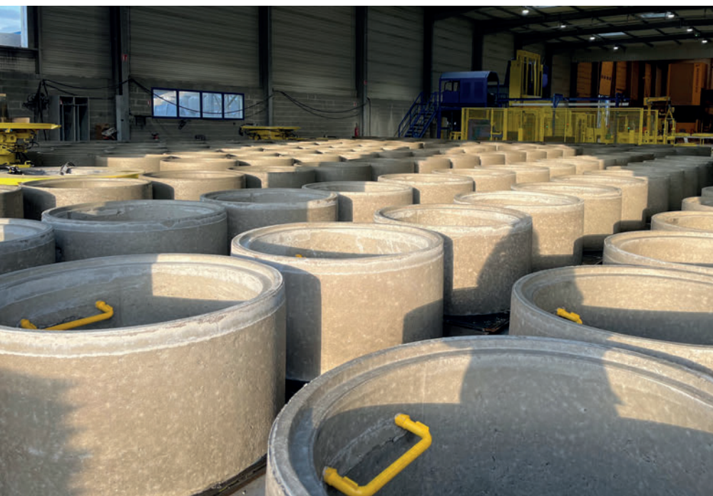
Éléments droits de regards, avec échelons et ancrés
