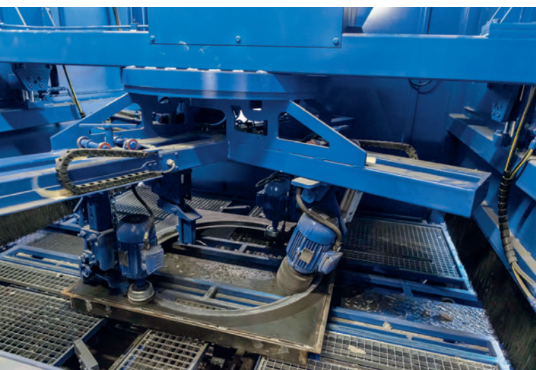
Station de nettoyage des embases, un classique sur les Palettiseurs Schlüsselbauer.
