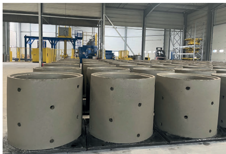
Position optimale de l'aire de séchage (ici avec buses de puits perforées) en angle entre la machine de production et le palettiseur.
