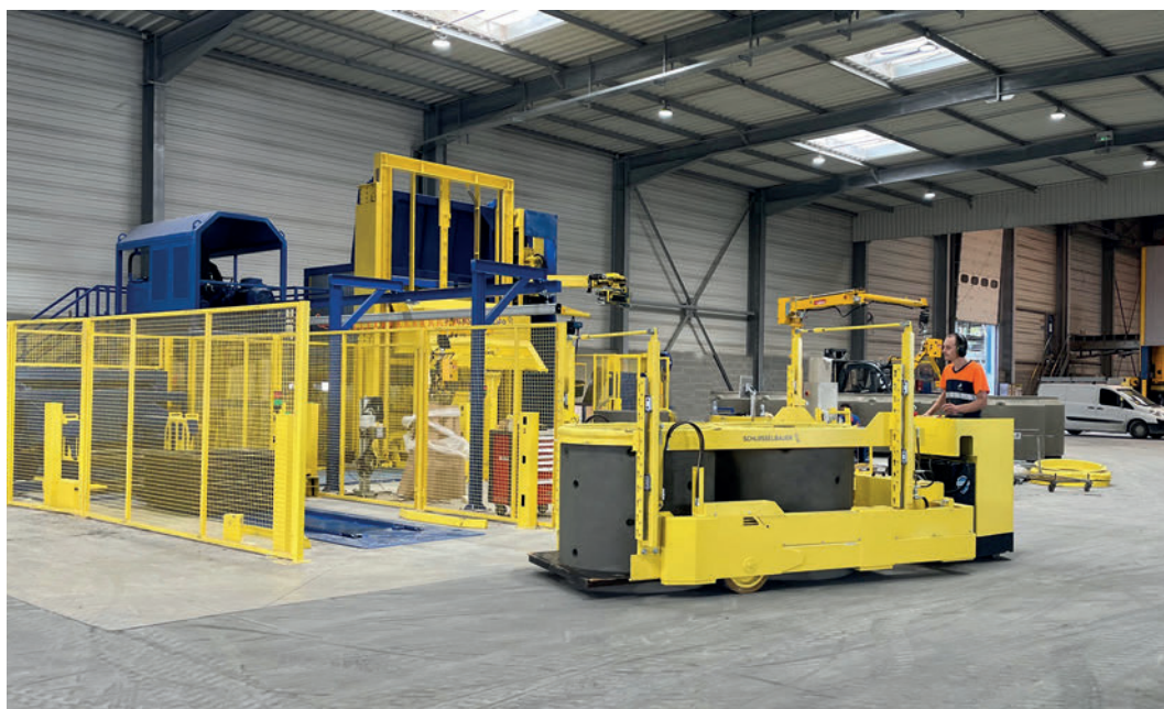
La mise en place automatique des ancrs comme celle des échelons s'effectuent ici par la droite et la trémie est déportée derrière le mur du bâtiment : la Magic a été adaptée sur mesure en fonction du site Plattard.
