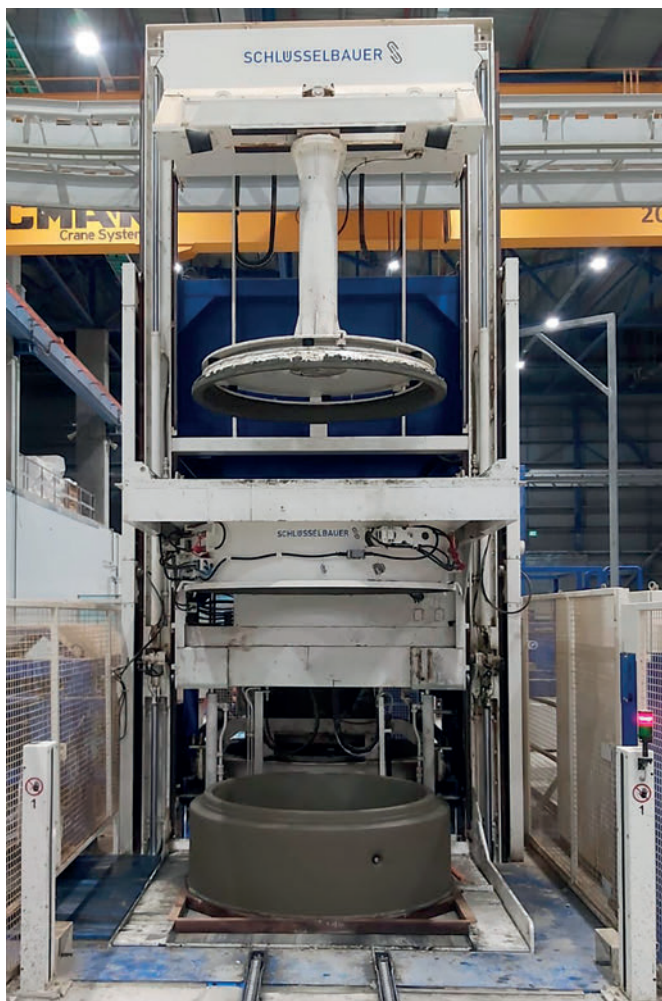
L'installation Magic est destinée à la production de masse de regards dans les diamètres nominaux 800, 1 000, 1 250 et 1 500 mm.
