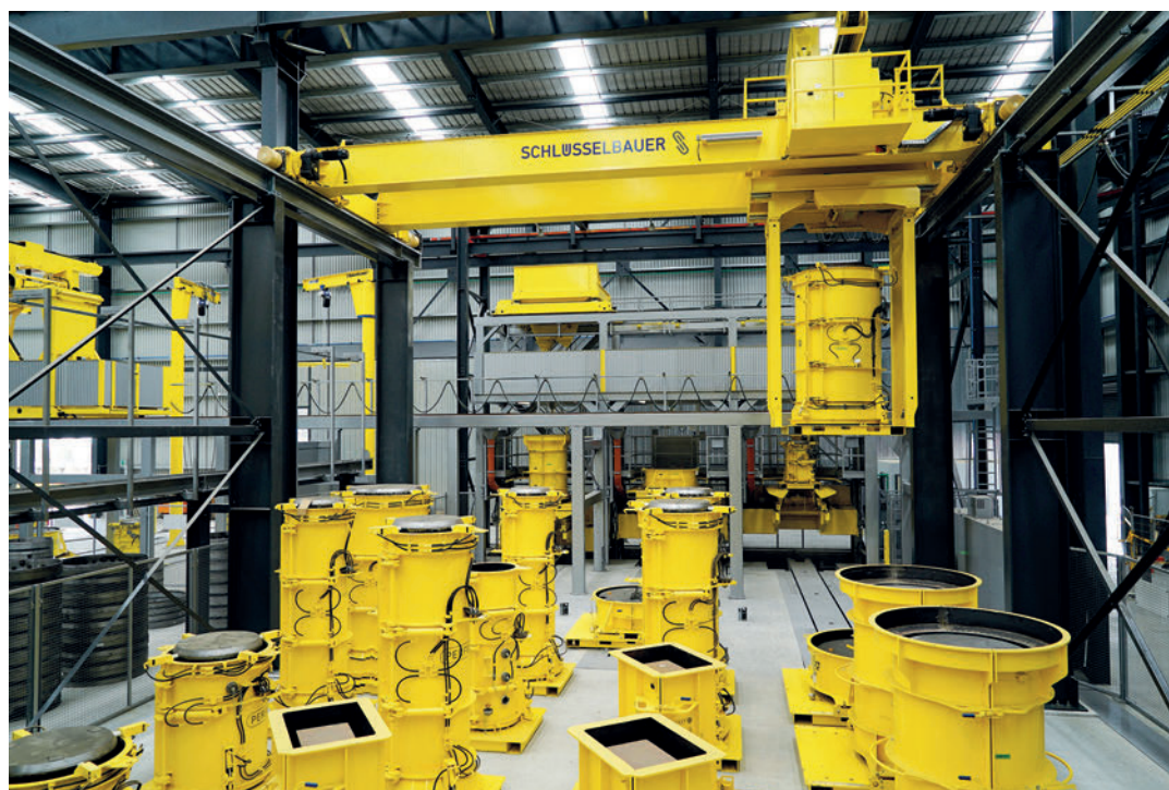
Variété de moules pour une production en démontage différencié de masse rentable
