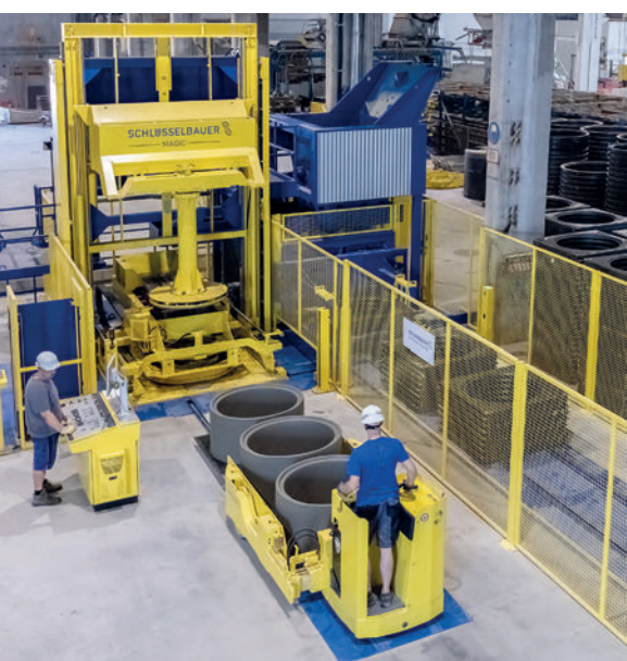
Les regards jusqu'au 1500 sont fabriqués sur l'installation Magic 1501 mise en service en 2021 (article détaillé dans la revue PBi, 01/2022).
