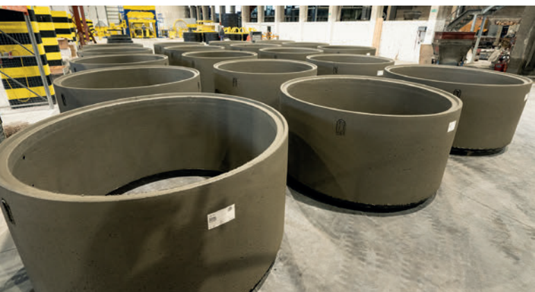
Une seule équipe produit quotidiennement jusqu'à 110 éléments de regards diamètre 2000 ou 90 en 2500 à Sollenau.
