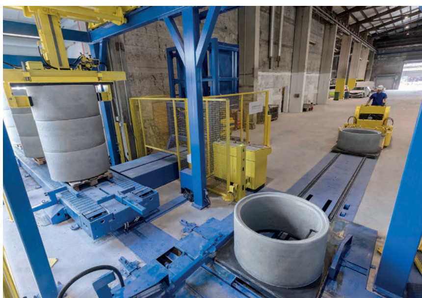
Les regards jusqu'au 1500 sont fabriqués sur l'installation Magic 1501 mise en service en 2021 (article détaillé dans la revue PBi, 01/2022).
