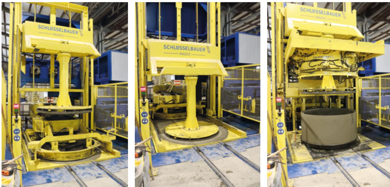
Le remplissage en béton de l'installation de fabrication Magic, le processus de compression et l'éjection du produit frais sont entièrement automatisés.
