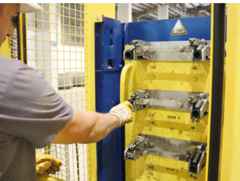
Insertion de douilles pour pose ultérieure d'échelons, en option dans le Stepmaster
