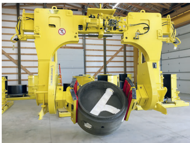
Pour démouler et retourner les produits en toute sécurité Precast Supply utilise un palonnier hydraulique de retournement
