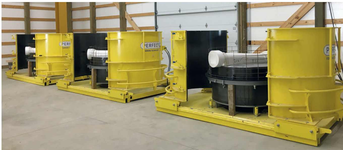
Les moules équipés d'une cunette EPS et d'une armature métallique sont prêts à être remplis de béton auto-plaçant
