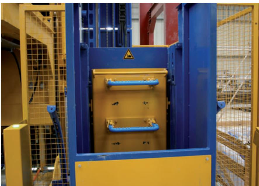
Le dispositif pour la mise en place automatique des échelons se nomme Stepmaster.
