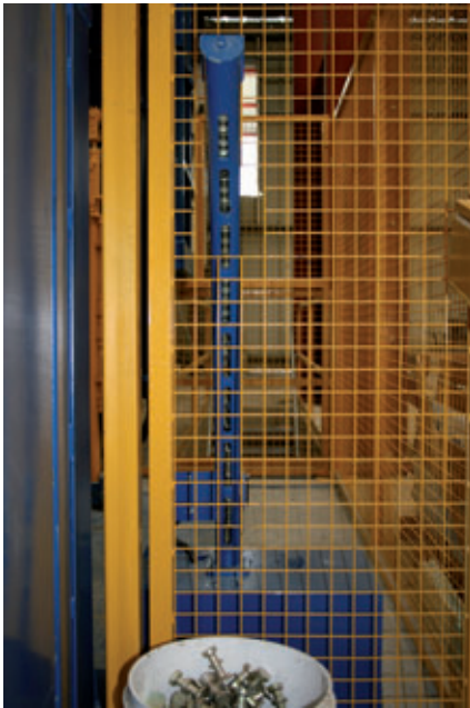
Une nouveauté dans la production de préfabriqués béton: le magasin d'ancres de manutention avec une capacité d'environ 25 ancres de chaque côté
