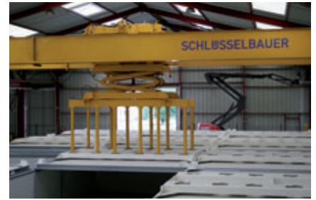
Le fait que les bras de prise de Transexact soient pivotants permet de manœuvrer les couvercles des étuves sans avoir à changer de bras
