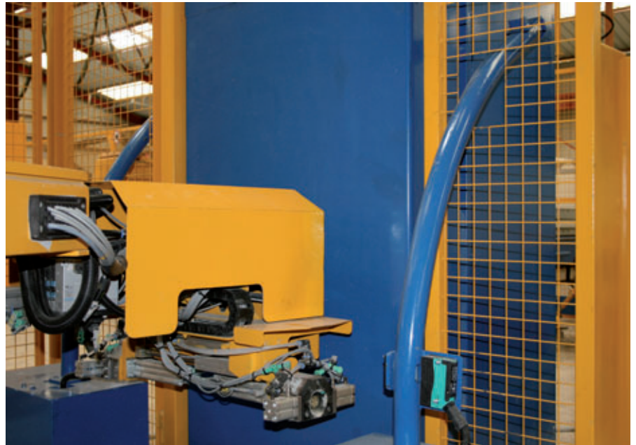
Le robot de mise en place des ancres se saisit automatiquement de deux ancres et les positionne sur l'élément de regard
