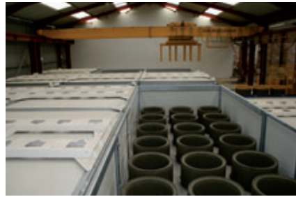
Les éléments de regard durcis, juste avant leur reprise par la grue-robot
