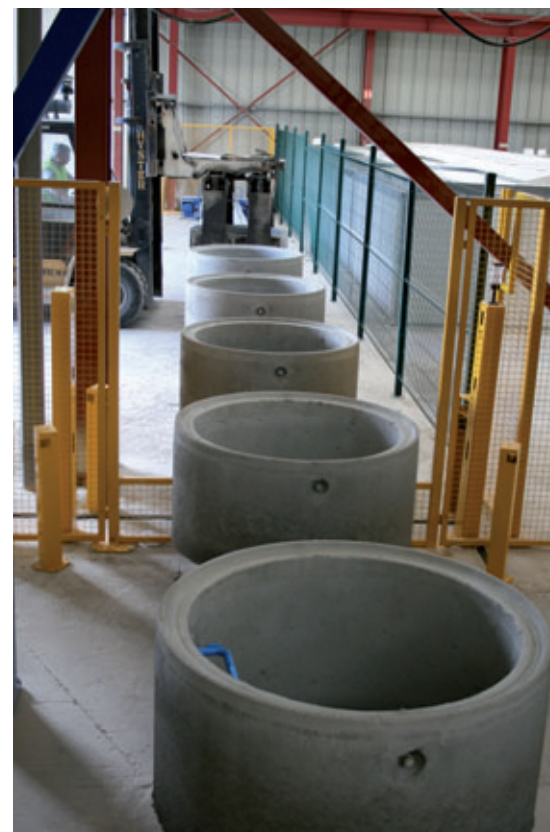
Les produits sur le convoyeur de sortie. Les pièces béton quittent le hall de production dès le poste suivant leur production.
