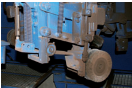
Les brosses métalliques débarrassent les embases des restes de béton
