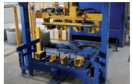
Une nouveauté développée par Schlüsselbauer : l'unité de changement automatique des mâchoires de la pince-produits
