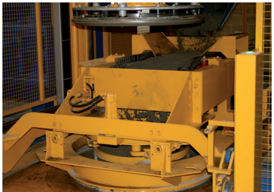
Le remplissage des moules est fonction de la dimension du produit mais reste toujours largement inférieur à 2 minutes
