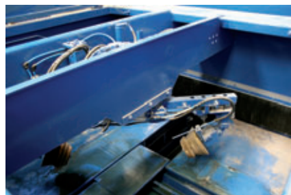
Les éponges de graissage permettent un graissage particulièrement efficace des embases
