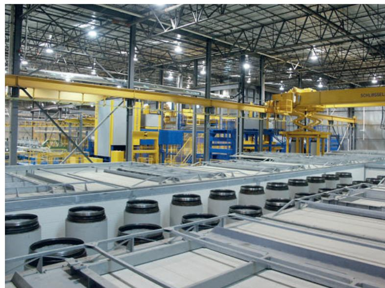
*Producción totalmente automática de tuberías de hormigón Exact 2500 empleando encofrados superiores de acero para unir tuberías de forma precisa y estanca.*
