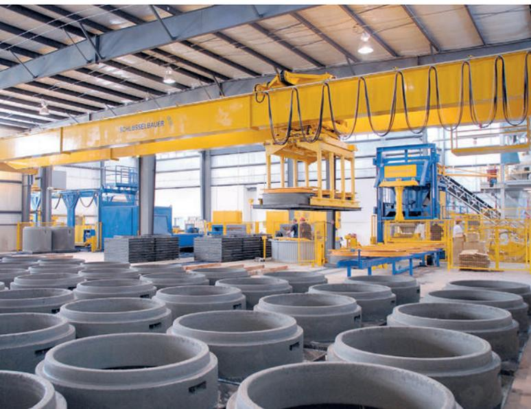
*En muchas instalaciones para la fabricación de componentes para pozos, la grúa automática permite aumentar la eficiencia en la producción.*
